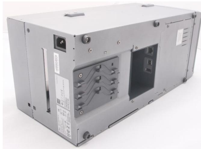
Коммуникационные порты расположены на дне принтера. Это решение позволяет защитить разъемы от попадания воды и грязи. А интересное решение для крепления проводов (см рис.), позволяет защитить от случайного вырывания провода из разъема.
